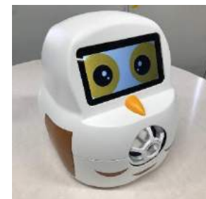
遠隔みまもり看護用対話ロボット ※ご当地ロボットとして自由に名称設定可
